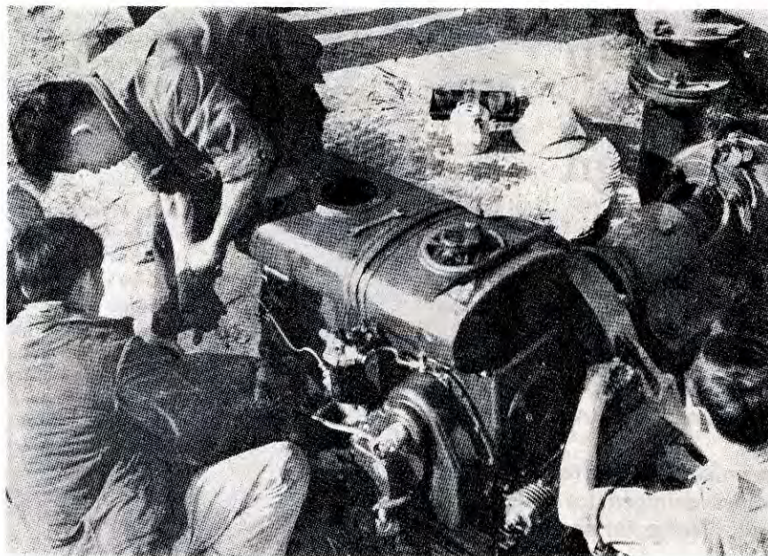
Arbeidere fra Thai Binh mekaniske verksted i Kien Xuong—distriktet reparerer en pumpemaskin.
